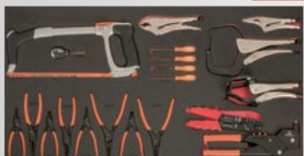
FF1B10LM Pílka na kov, kliešte na poistné krúžky a pridržiavacie kliešte
